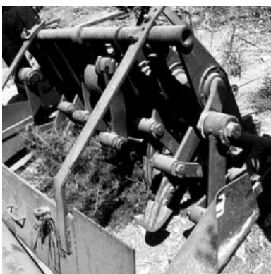
ハウスの深耕に使うというクランク式の耕耘機（イタリア製）。ハウス内でもトラクタは70ps前後のものが入る。耕耘後、ロータリーで砕土、整地をする。
